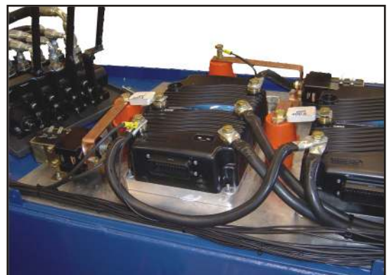
Controladores eletrônicos Curtis (Corrente Alternada) e comando hidráulico Sauer Danfoss.
