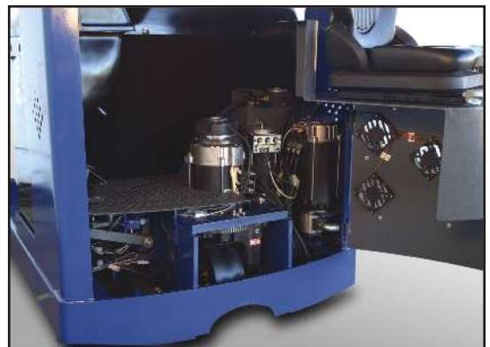
Transmissão ZF, bomba hidráulica Bosch e motores Sauer Danfoss (direção, elevação e tração).
